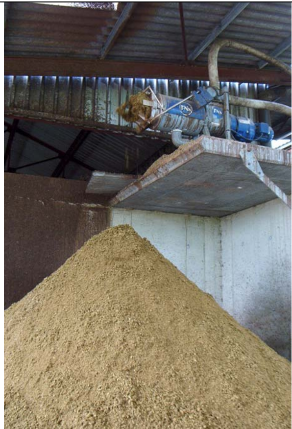
Séparateur et tas constitué par les solides (une partie sert pour la litière, une partie est vendue à des particuliers)
