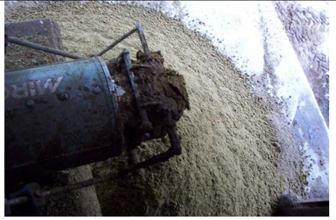
Le solide (env. 28% TS) sortant doucement et poussé par une vis intérieure d'archimède.
