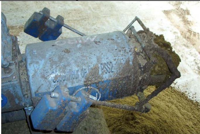
Le solide est pressé à l'aide de 2 pinces (avec contreponds)
